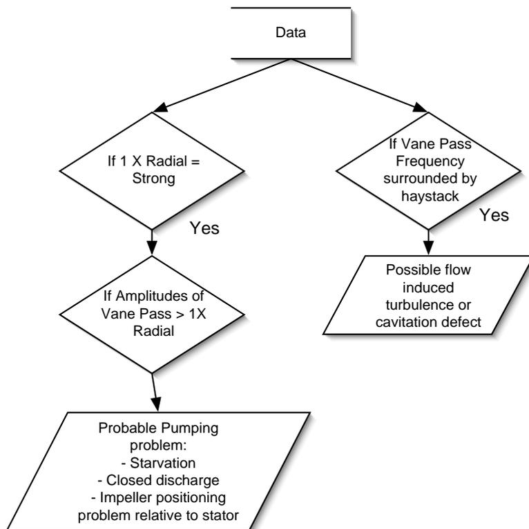
**Figure C.22:** *Centrifugal Pump Faults.*
